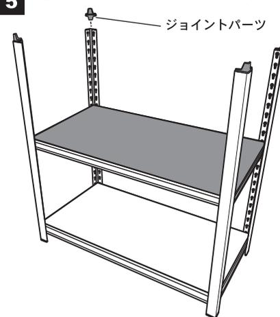
**6** セットしたジョイントパーツに、支柱、支柱キャップを取付けます。
