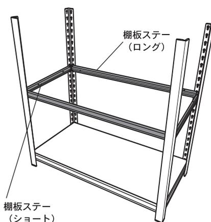
**5** 支柱にジョイントパーツを取付けてください。
